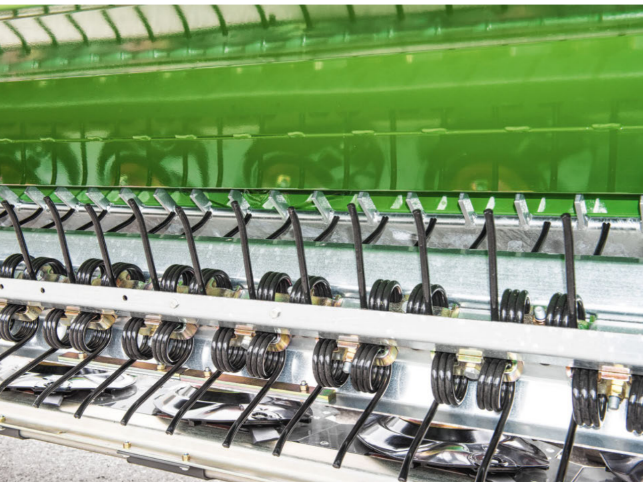
Пальцева плющилка: агресивніша, ніж вальцева плющилка. Травостій, польові кормові культури тощо.
