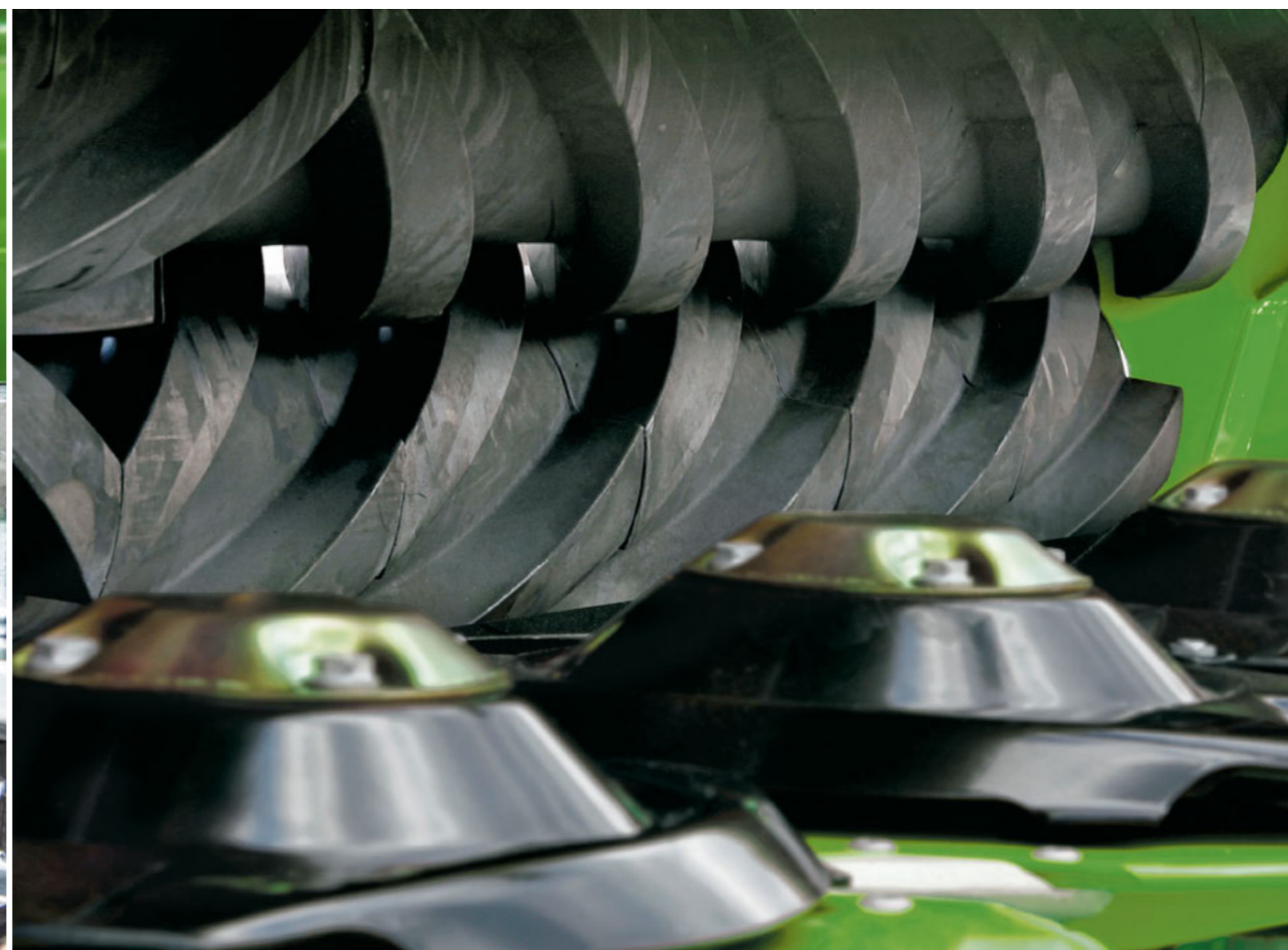
Вальцова плющилка: бобові, наприклад, люцерна та конюшина. Працює м'якше, ніж пальцева плющилка.
